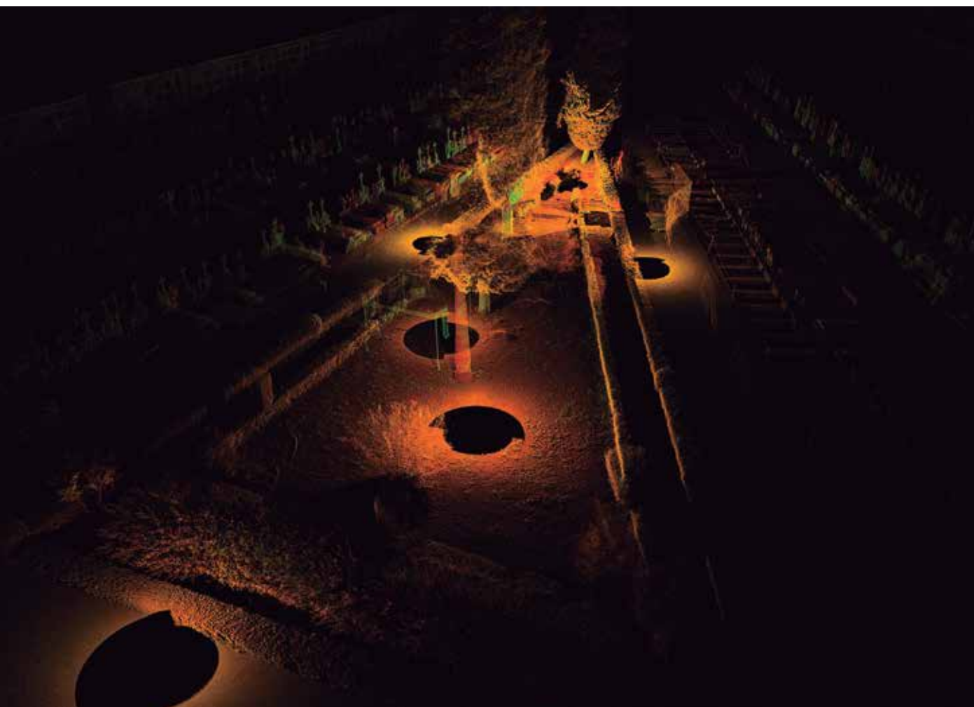
Imagen del barrido general del área del Pico Reja con escáner laser.
